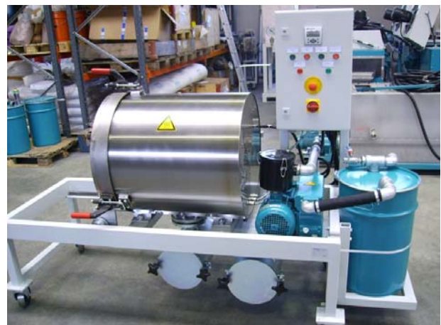
Abb. Das Pyrolyseofen-System mit dem Abgasfilter (blauer Container)
